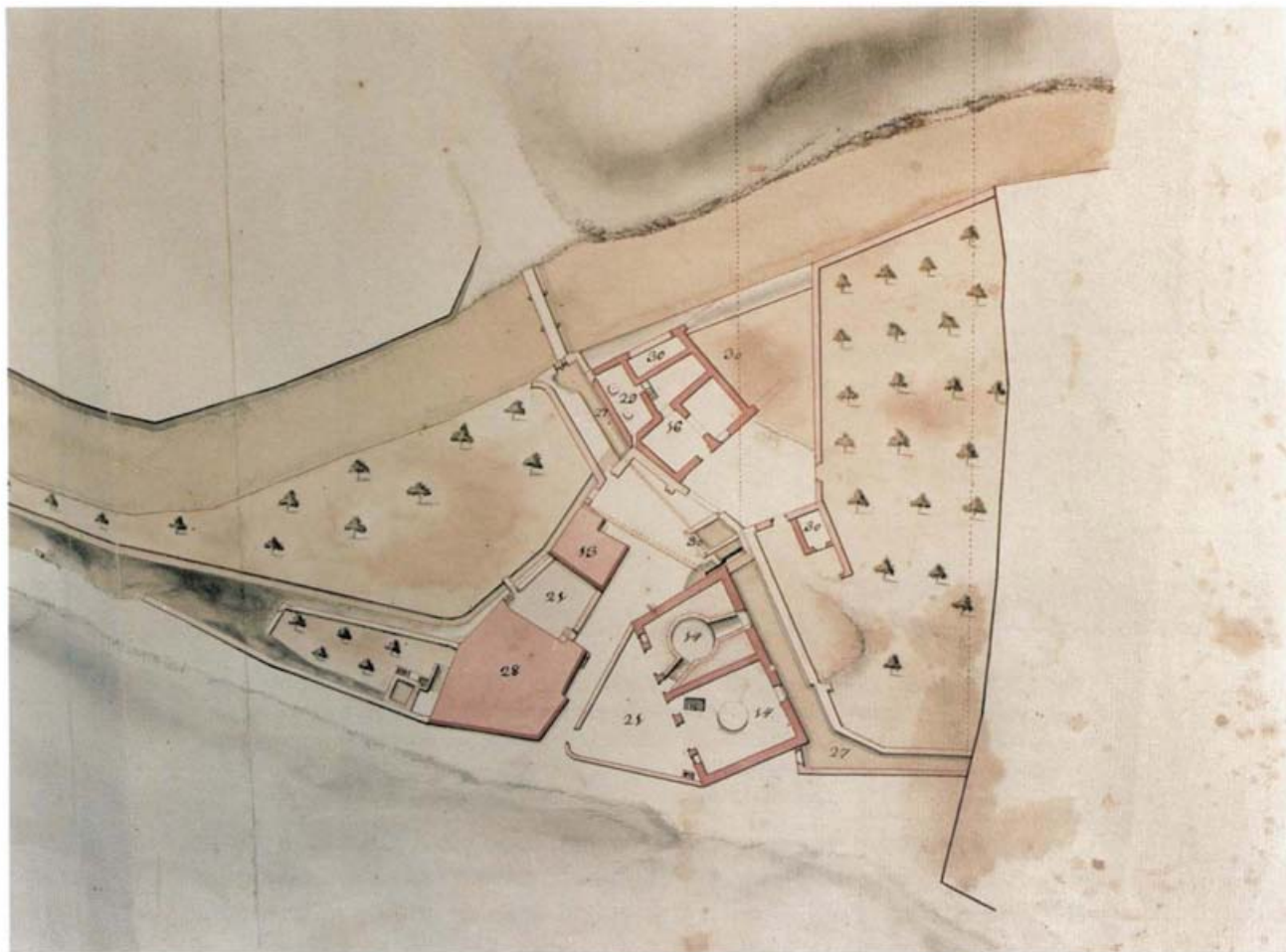
Fig. 13 - Fragmento da planta de 1775 relativo à zona da Fábrica de Cima, onde existiam dois engenhos (original no Centro de Estudos Arqueológicos de Engenharia Militar). A água provinha dum canal, provavelmente com origem no actual açude, e, depois de accionar as azenhas, seguia por canal para a Fábrica de Baixo.
