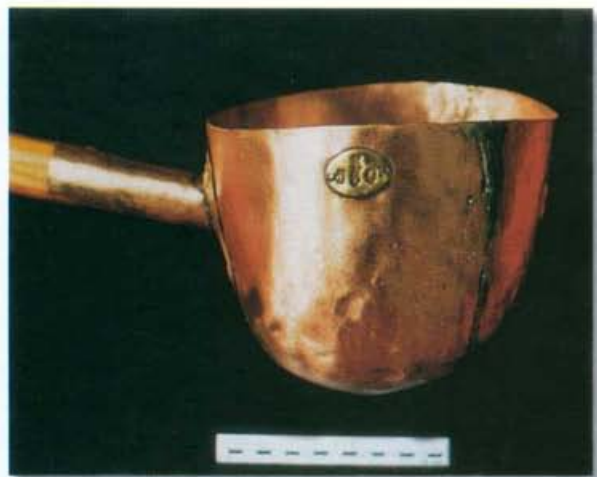
Fig. 51 - Casso de cobre, utilizado na Fábrica da Pólvora de Barcarena no caldeamento do líquido salitroso.
