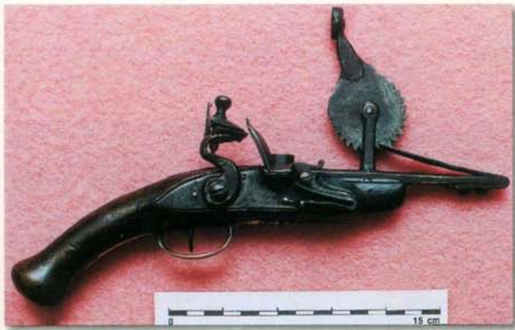
Fig. 58 - Provador da pólvora (pistola-provete), de pederneira e roda dentada, do século XVIII.
