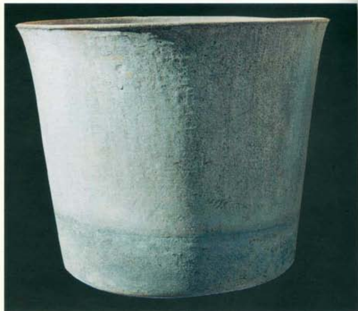
Fig. 52 - Cristalizador da Fábrica da Pólvora de Barcarena para a refinação, a quente, do líquido salitroso.
