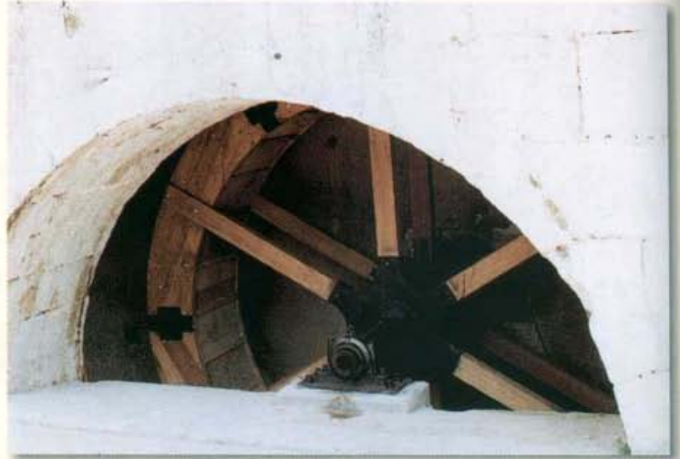
Fig. 48 - Reconstituição de roda de azenha, de madeira, para accionar engenho de galgas da Fábrica de Baixo. Projecto de A. C. Quintela, J. M. Mascarenhas e J. L. Cardoso; execução da Firma Brito & Silva, Lda.
