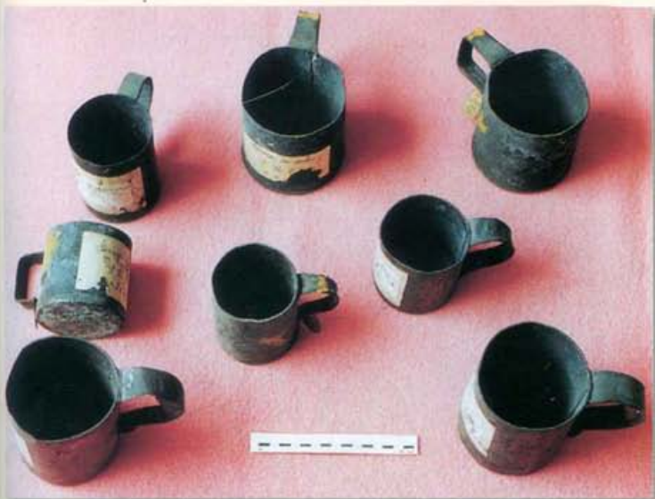
Fig 55 - Conjunto de oito medidas de cobre, para doseamento de 1 kg ou de 1/2 kg de pólvora ou dos seus componentes, da Fábrica da Pólvora de Barcarena.
