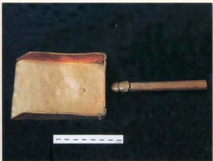
Fig. 54 - Pá de cobre, para manuseamento da pólvora ou dos seus componentes, da Fábrica da Pólvora de Barcarena.
