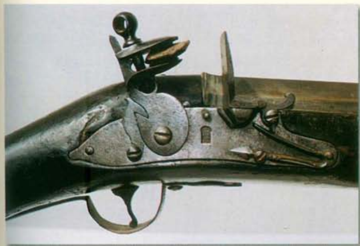
Fig. 8 - Bacamarte naval de Barcarena (ver Fig. 7, em baixo). Pormenor do fecho de pedreira “à francesa”, com patilha de segurança traseira e punção com as armas reais portuguesas, da segunda metade do século XVII.
