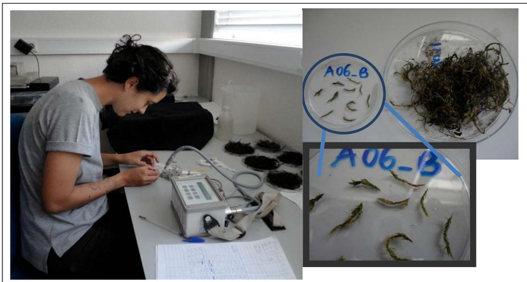
**Figura 3.4.1:** Análise de vitalidade das amostras recolhidas (3 cm apicais hidratados) utilizando o fluorómetro portátil MINI-PAM 101 (Photosynthesis Yield Analyzer); exemplo de uma amostra (A06) analisada.
