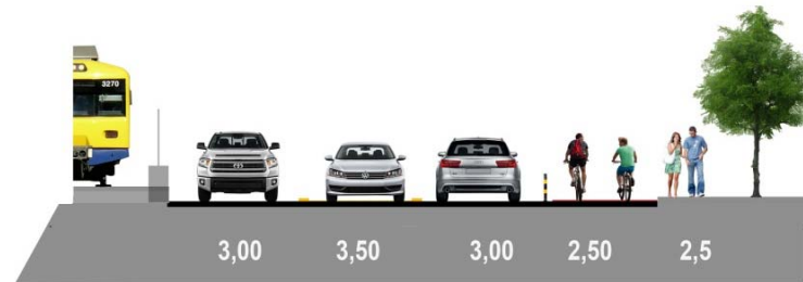
Figura 12 – Rede ciclável proposta no trecho da Av. Marginal entre a Cruz Quebrada e Algés: perspetiva da proposta e perfil-tipo
