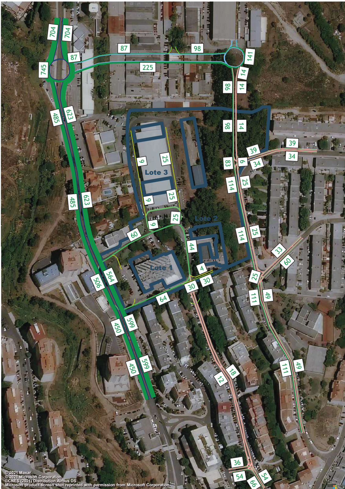
Figura 32 – Volumes de tráfego (macro modelo de tráfego em PTV Visum, HPM-DU, Ano Horizonte, Cenário A) (uvle/hora)
