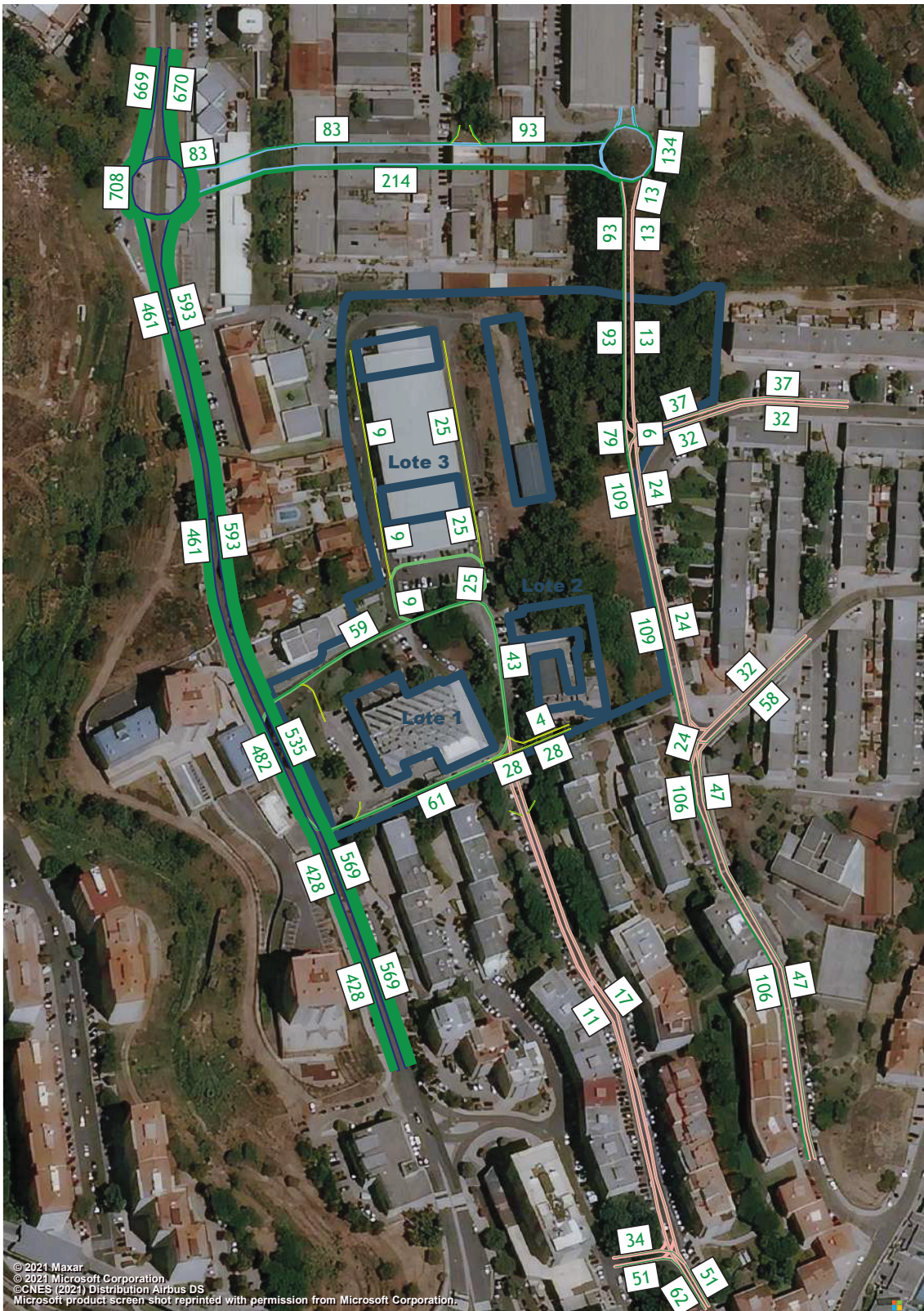
Figura 26 – Volumes de tráfego (macro modelo de tráfego em PTV Visum, HPM-DU, Ano Base, Cenário A) (uvle/hora)
