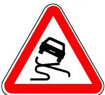
A5 – Pavimento escorregadio
