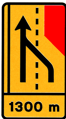
ST2 – Supressão de via de trânsito
