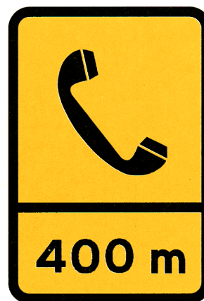
ST12 – Telefone de emergência
