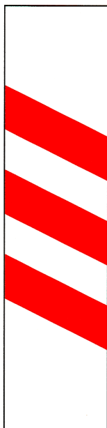
19d – Aproximação de passagem de nível
