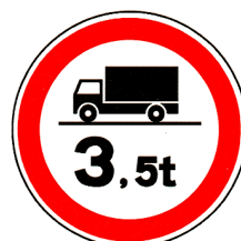
C3d – Trânsito proibido a automóveis de mercadorias de peso total superior a ... toneladas
