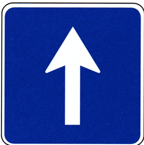
H3 – Trânsito de sentido único
