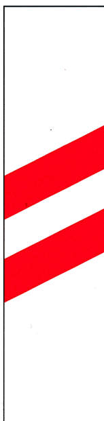
19b – Aproximação de passagem de nível
