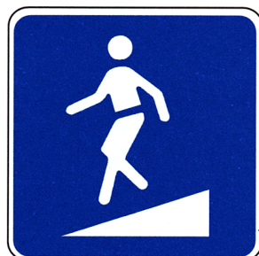
H8a – Passagem desnivelada para peões
