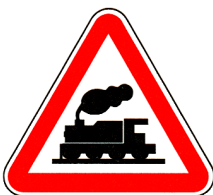
A27 – Passagem de nível sem guarda
