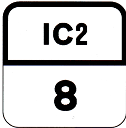
02c – Demarcação quilométrica da via – IC
