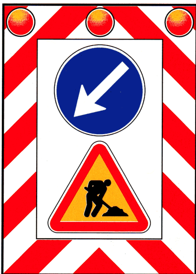
ET12 – Atrilado de balizamento
