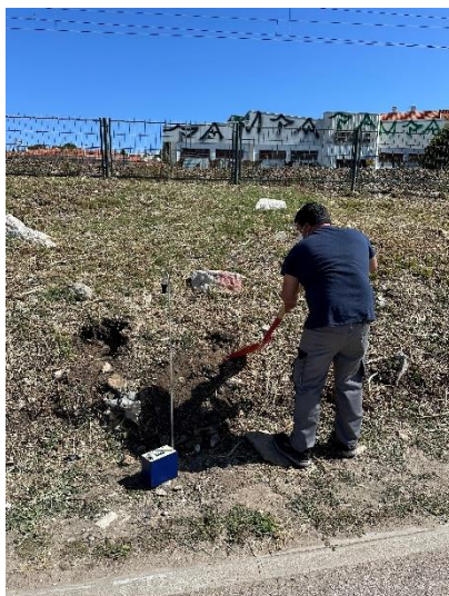
Medição de fibras de amianto no ar em buraco com detritos de fibrocimento.
