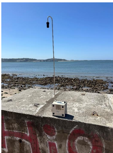
Medição da concentração de fibras de amianto em suspensão no ar.
