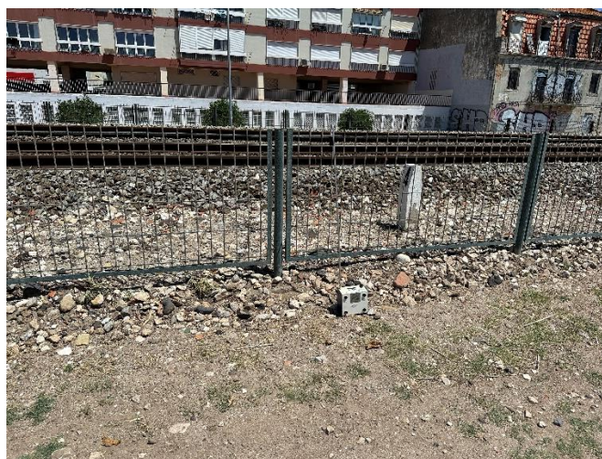
Medição da concentração de fibras de amianto em suspensão no ar.
