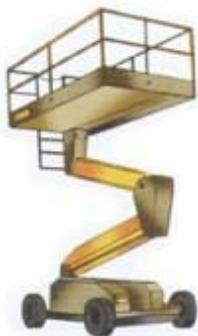
A utilização de plataformas de trabalho elevatórias, também designadas por plataforma móveis, representa uma medida de proteção para a criação de locais de trabalho, em altura, seguros. Trata-se de uma medida preventiva com efeito direto, pois evita-se uma queda de altura mediante medidas técnicas.
