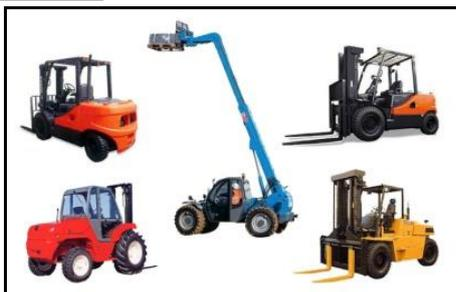
Empilhador é uma máquina usada principalmente para carregar e descarregar mercadorias, levantar, baixar, transportar e empurrar cargas.
