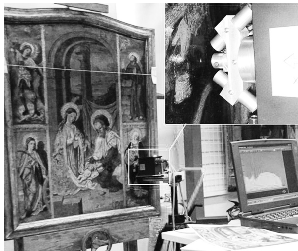
Fig. 3 – Análisis in situ por fluorescencia de rayos X.
